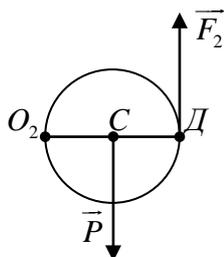
Запишем условие равновесия сил  $\vec{P}$  и  $\vec{F}_2$ . Плечо силы  $P$  равно  $O_2C$ , а плечо  $F_2 = O_2D = 2O_2C$ .
