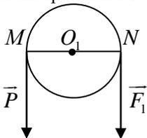
При вращении блока относительно точки  $O_1$  плечи сил  $\vec{P}$  и  $\vec{F}_1$  равны, т.к.  $O_1M = O_1N$ .
